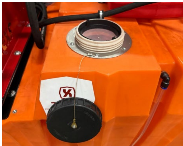
Figura 8. Bocal de abastecimento de abertura 110 mm, com tela para filtragem de impurezas e tampa com cabo de segurança, para evitar perdas.
