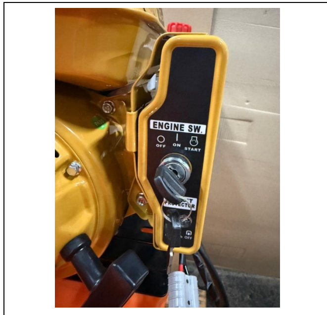
Figura 17. Partida elétrica usando a chave: girar até START. Partida manual: colocar a chave na posição ON e puxar a feira.
