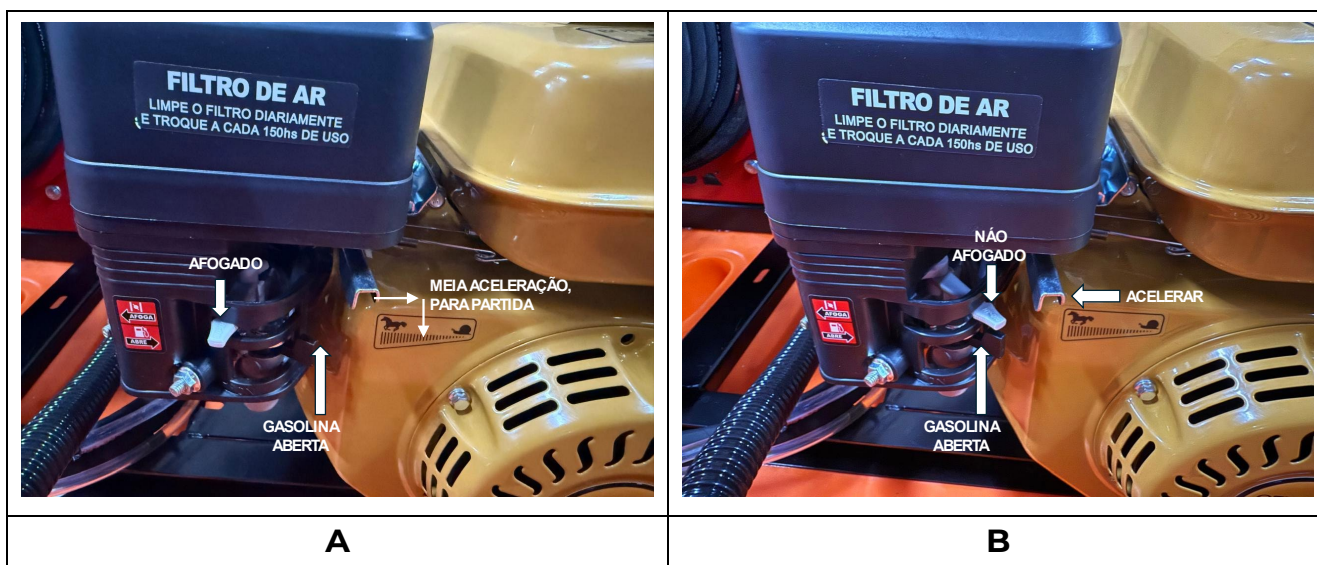
Figura 16. A = posição inicial para partida; B . = posição após partida do motor.
