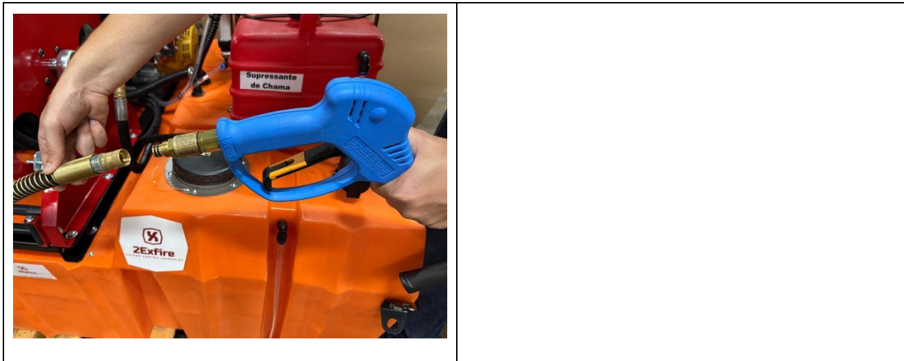
Figura 11. Engate rápido rosqueável com a mão, entre mangueira de combate a incêndios e pistola, em latão e duplo anel oring, para segurança.
